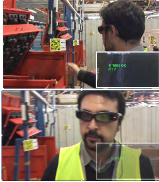
Şekil 1. Kullanılacak olan artırılmış gerçeklik gözlüğü ve çalışan gözü önüne gelen net bilgi
